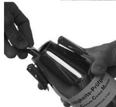
5) Inclinare lo strumento CM ed inserire la fiala con il carburo di calcio
