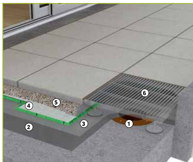
Griglia di drenaggio AquaDrain® DR per il drenaggio del pozzetto di scarico
